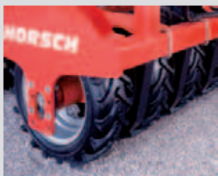
Oponowy wał ugniatający z oponami o bieżniku ciągnikowym
