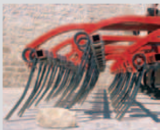
3-rzędowa brona z niezależnym mocowaniem każdego rzędu
