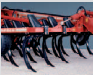
Małe szerokości robocze zębów zapewniają intensywne mieszanie
