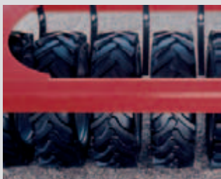
Wał oponowy z ciągnikowym śladem bieēnika
