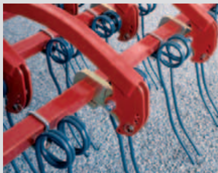
Każda belka brony może być indywidualnie regulowana w celu optymalnej pracy w danych warunkach, na odpowiedniej głębokości.
