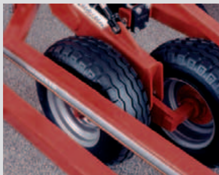
Podwójne koła pozwalają na dokładne utrzymanie głębokości roboczej i płynną pracę.
