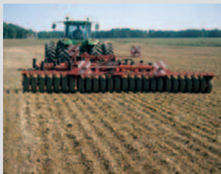
Ciągnikowy profil opon zapewnia pozostawienie odpowiedniej struktury przywałowanej powierzchni.
