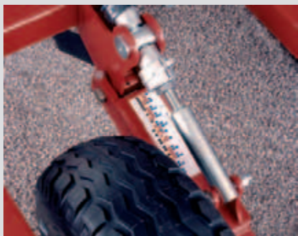
Głębokość robocza jest regulowana za pomocą aluminiowych klipsów.
