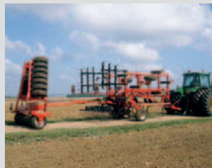
Do transportu boczne sekcje są składane w górę. Również dyszel może być skrócony. Wał jest transportowany na kołach środkowej sekcji.
