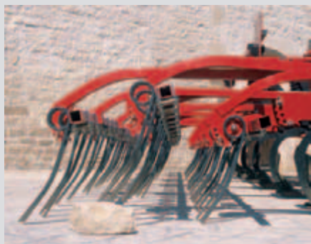
Trzy niezależnie zawieszane i regulowane belki zapewniają doskonałe rozgarnianie słomy i małą wrażliwość na zapychanie.
