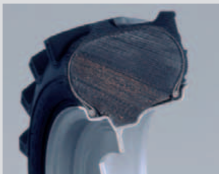
Opony standardowo wypełnione są elastyczną pianką poliuretanową co zapewnia odporność na uderzenia kamieni.
