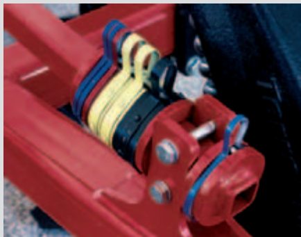
Klipsy odległościowe o różnych kolorach i grubościach są używane do regulacji głębokości pracy a ich zmiana jest łatwa i szybka.
