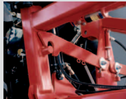
Blokada transportowa jest otwierana i zamykana z ciągnika. Traktorzysta nie musi wysiadać z kabiny.
