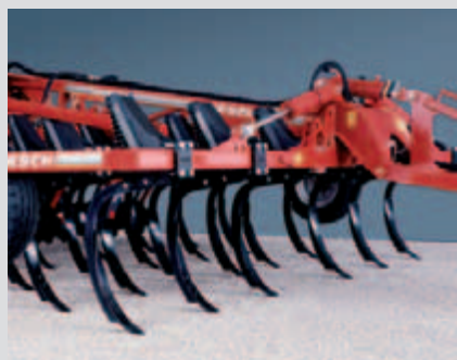
Niewielkie odległości robocze zębów zapewniają intensywne mieszanie.
